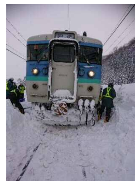
人力による除雪作業
